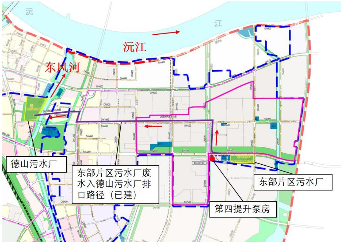
图 5.2-5 常德经开区东部片区污水排放路径示意图
